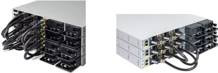
图 4. 思科 Catalyst 9300 系列模块化上行链路型号堆叠 (C9300 SKU) 和非模块化上行链路型号堆叠 (C9300L SKU)
