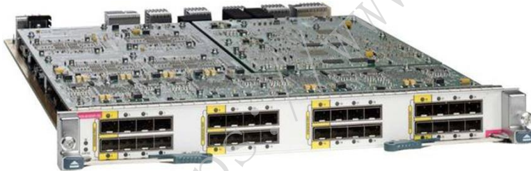
图 1. 配置 XL 选项的 Cisco Nexus 7000 M1 系列 32 端口万兆以太网模块
